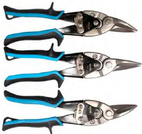
Ножницы по металлу представляют собой удобный инструмент для обрезания листового металла.
