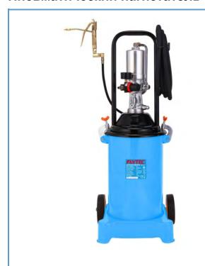
Пневматический нагнетатель густой смазки выполняет снабжение различных механизмов и оборудования солидолом. Отличается высокой скоростью подачи рабочей жидкости.
